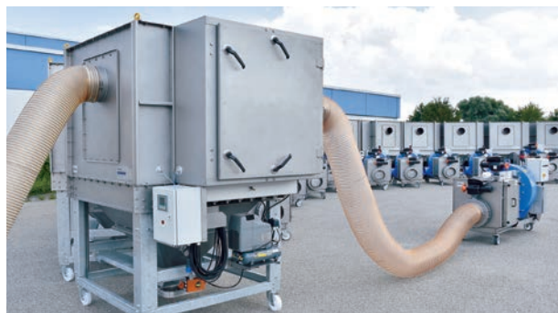
AMF-K, состоящий из: Мобильного модуля фильтра предварительной очистки с возможностью регенерации M-TPGT 43-2/8-M6), соединенного с модулем вторичного предохранительного фильтра M-SCF 1x1-H13-Fan
