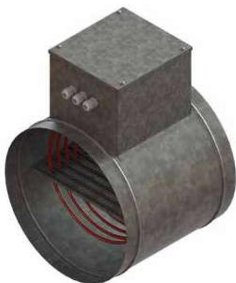
Круглые электрические нагреватели имеют два термостата в стандартной комплектации. Первый термостат настроен на 70 °С, воздух в электронагревателе отключает электрический ток, когда он достигает 70 °С, позволяя устройству автоматически перезапускаться при падении температуры. Второй термостат, используемый в целях безопасности, активируется при 110 °С и отключает электрический ток. Термостат должен быть сброшен вручную с красной кнопки, чтобы прибор снова заработал.
