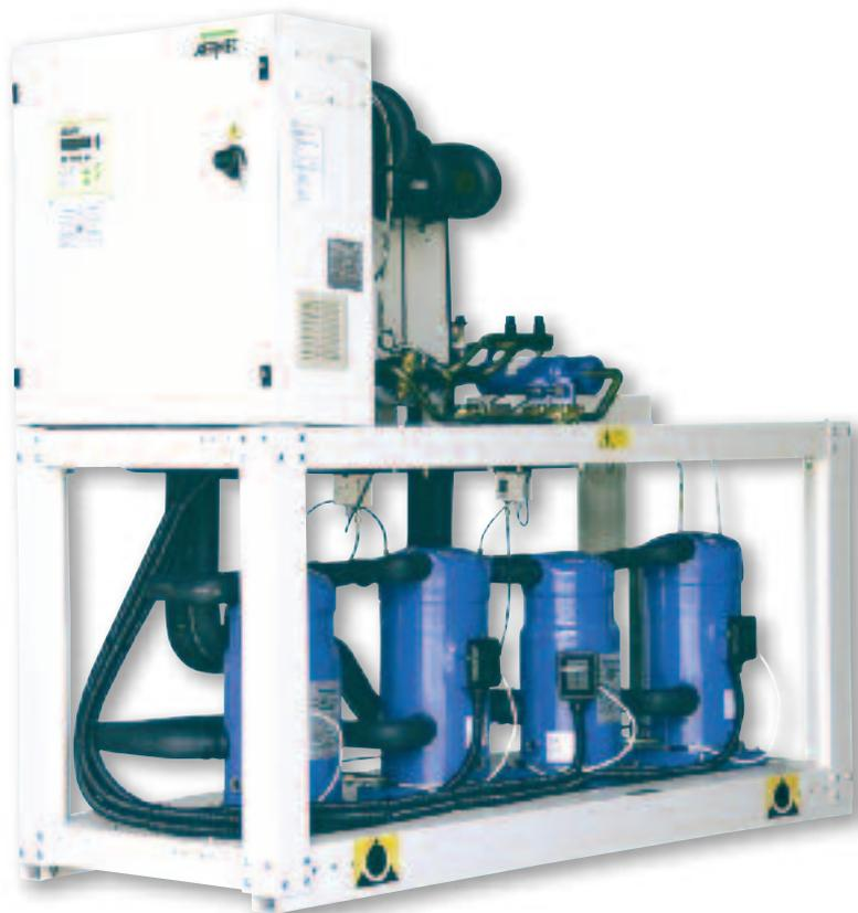
Водо-водяные холодильные машины серии NLW, оборудованные несколькими компрессорами, обладают высокой экономичностью даже при неполной нагрузке благодаря тому, что в зависимости от нагрузки используется разное число компрессоров. При этом каждый из работающих в данный момент компрессоров развивает полную мощность, что гарантирует минимальное энергопотребление холодильной машины.
